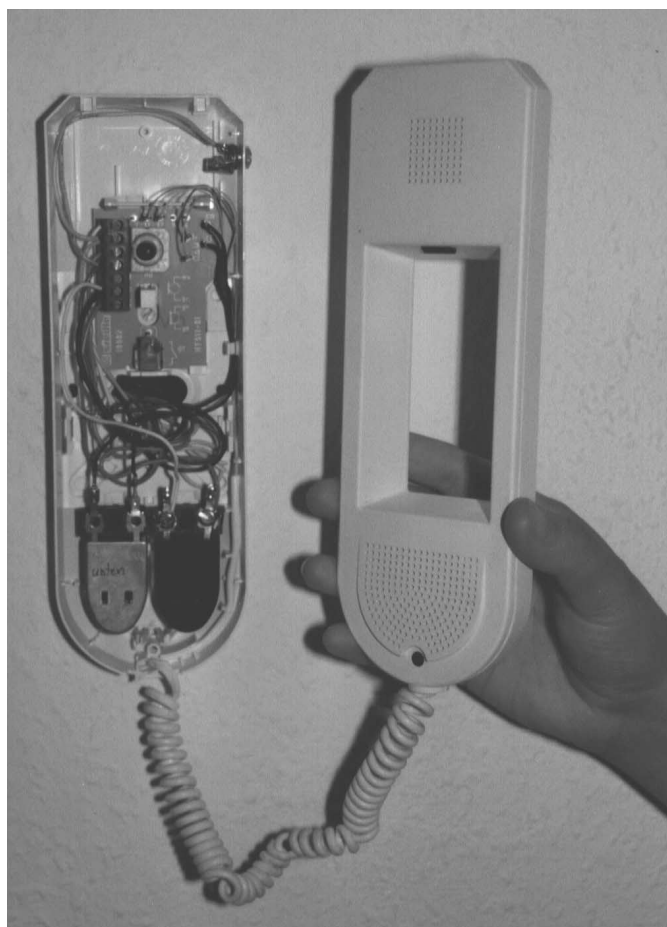
Über eine Haussprechanlage kann jeder durch eine kleine Manipulation – den Einbau einer Abhörbuchse (oben rechts im geöffneten Gerät zu sehen) – die anderen Hausbewohner belauschen. Foto: Görrisch
