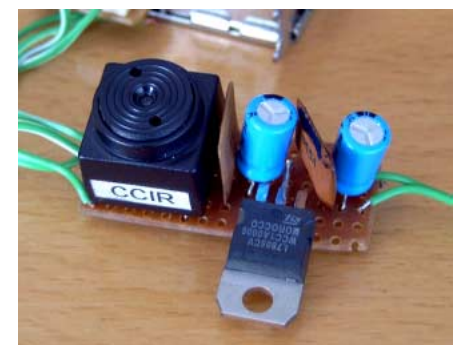
Ein Kameramodul mit SST: Miniaturkamera mit 5-Volt-Stabilisierung auf einer Platine. Die Abbildung zeigt ein Normalobjektiv.
