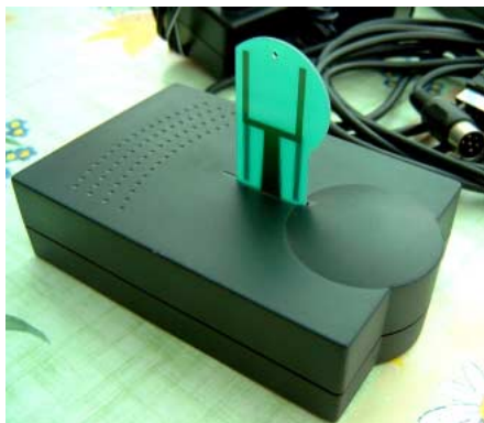
Anschlussfertiges 12-Volt-Video-Modul aus dem TV-Bereich für 2,4 GHz.
