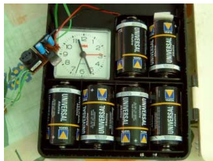
Das „Gesamtkunstwerk“: Anordnung der Bauteile im Kunststoffgehäuse, einer Schraubenschachtel aus dem Baumarkt.
