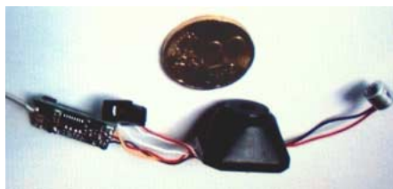
Kauffertiges Modul: anschlussfertige Sendeeinheit mit Kamera – eine Alternative zum Einbaumodul.
