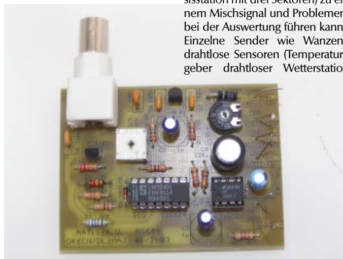
Gelötete Platine des Bausatzes: Der MAX4000 SMD-Schaltkreis befindet sich auf der Rückseite.
