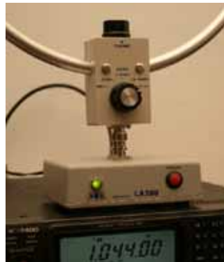
Die Antenne LA380 von AOR empfängt auch aus Innenräumen ausgezeichnet. Ihr Empfangsbereich umfasst 10 kHz bis 500 MHz. Foto: Brodien
