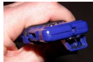
Der feststehende Umlenkspiegel ist gut zu erkennen. Foto: Fuchs
