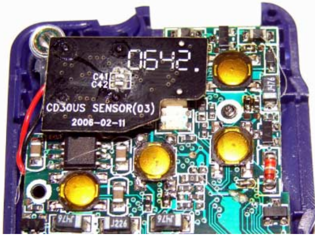
Rückseite: Die CMOS-Platine wurde freigelegt. Foto: Fuchs
